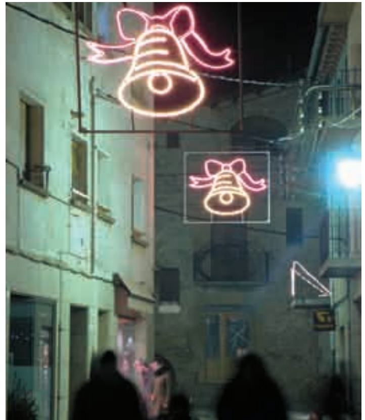
Campanas suspendidas con tirantes en una calle peatonal estrecha Campanes suspeses amb tirants en un carrer peatonal de poca amplada Foto: Prov Barcelona
